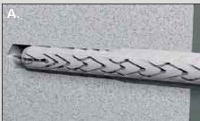
A. Die zwei Spreizzonen vereinen sich im Porenbeton und Vollbaustoffen zu einem langen Spreizelement und garantieren eine gleichmäßige, flächige Lastverteilung in den Untergrund.
