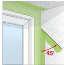
Bild 3: Überstehende Folie mit dem Reißfaden unter 45° abreißen.
