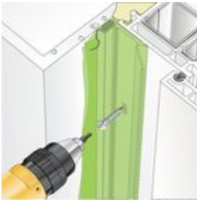
Bild 2: Befestigung mit geeigneten Schrauben.
